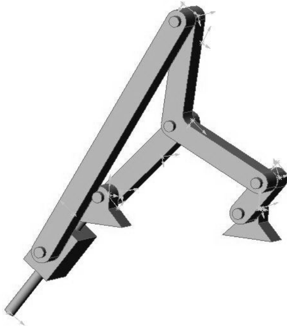
Рис. 2. Модель важільного механізму із зупинкою вихідної ланки, побудованого за допомогою точки Бурместера
