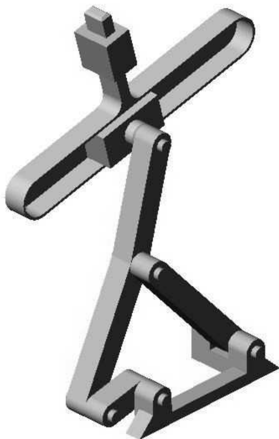
Рис. 6 – Модель важільного шестиланкового механізму, створена у системі SolidWorks
